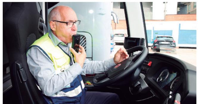
La mise en œuvre de contrôles préventifs de la consommation d'alcool et de drogues, ainsi que le système Alcolock, un dispositif dont la technologie empêche toute personne sous les effets de l'alcool de faire démarrer le véhicule, sont des systèmes que l'organisation s'est engagée à mettre en œuvre pour réduire les risques liés à la conduite sous l'influence de l'alcool et des drogues et garantir la sécurité de ses clients.
